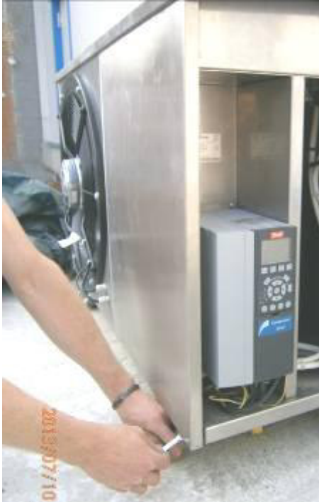
2 Sechskantschrauben lösen (SW8)
