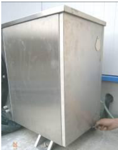
2 Sechskantschrauben lösen (SW8)
