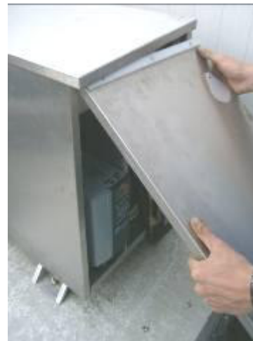
Seitenteil aus dem Deckel entfernen
